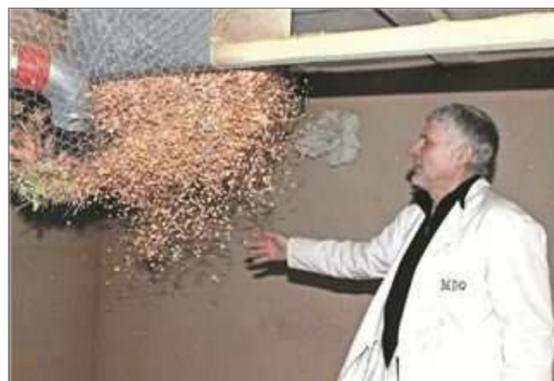
Sogleich nach seiner Herstellung wird das Konfetti durch ein Rohr in den Lagerraum geblasen.
